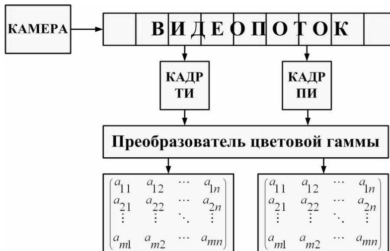
Рис. 2. Схема обработки изображения
